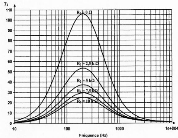
2.a) D'après le diagramme de Bode, la fonction F<sub>2</sub> réalise un filtre passe bande.
